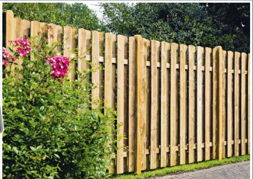
HEIKO-Gartenzaun Gefertigt aus Kiefer/Fichte, druck-imprägniert grün, Latten ca. 20 x 90 mm, glatt, Kopf ge- rundet. Riegel ca. 28 x 70 mm, alle Verbindungen genagelt (verzinkt)
