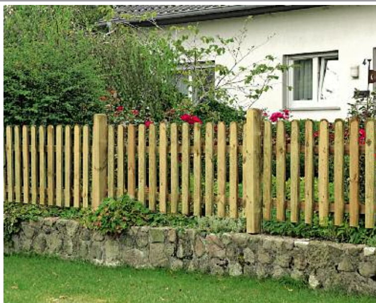
HEIKO-Gartenzaun Gefertigt aus Kiefer/Fichte, druck-imprägniert grün, Latten ca. 20 x 90 mm, glatt, Kopf ge- rundet. Riegel ca. 28 x 70 mm, alle Verbindungen genagelt (verzinkt)
